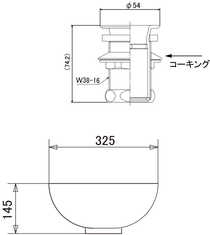
※取付穴サイズ: 約  $\phi 60\text{mm}$
